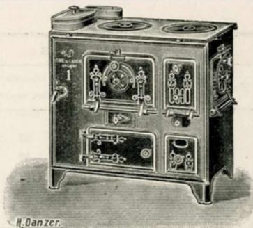
Ces appareils, construits en fonte et tôle, se recommandent par leur construction solide, irréprochable et par la simplicité de leur fonctionnement. Les foyers de ces cuisinières se changent facilement. Les fours et étuves sont chauffés par la flamme ambiante. Les passages de fumée sont très larges. — Depuis de longues années ils sont appréciés des connaisseurs, qui brûlent de l'anthracite.
